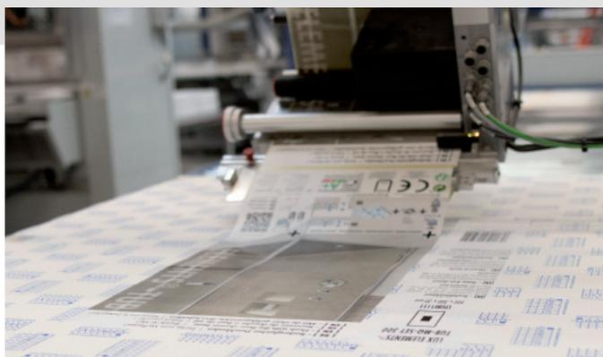
layout di stampa tramite il software iDesign, che viene in dotazione con la stampante. L'utente può trasferire il layout di stampa tramite una chiavetta. La Handhold può tenere in memoria fino a 9 layout. Quando il prodotto cambia, l'utente può cambiare il testo da stampare, premendo soltanto un pulsante.
